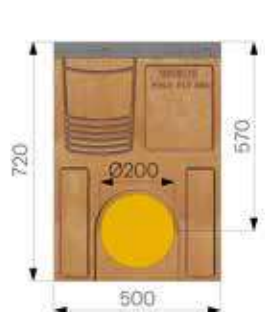
Pozzetto in cemento polimerico con profili zincati
