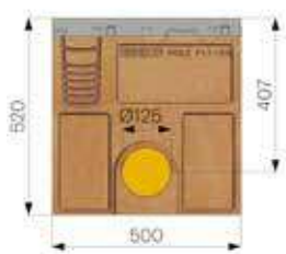
Pozzetto in cemento polimerico con profili inox
