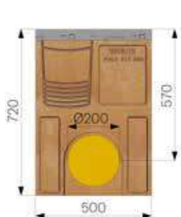
Pozzetto in cemento polimerico con profili inox
